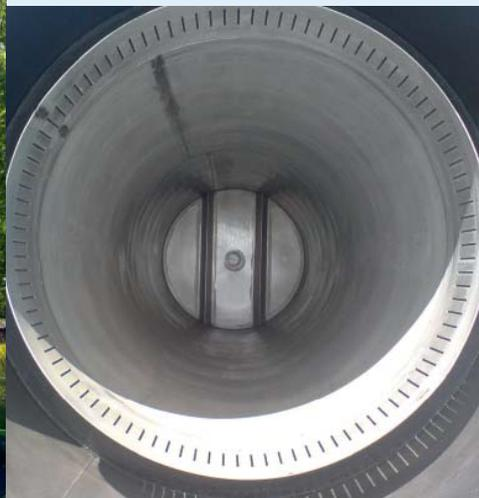
Einfache Bauweise des IONERGY®-MBBR-Aerobreaktors, keine inneren Einbauten
