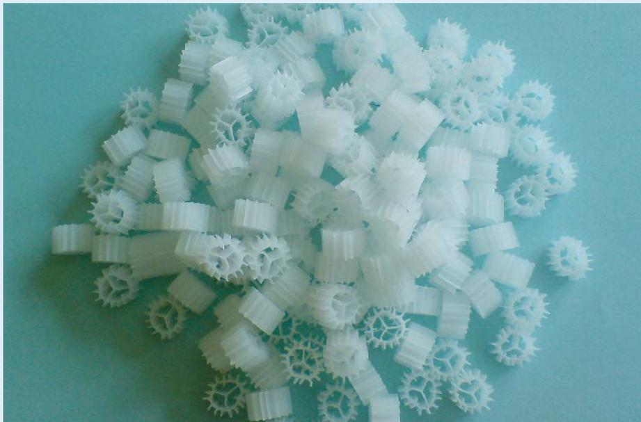
Kunststoffträgermaterial mit einem Durchmesser von etwa 10 mm Bild 2
